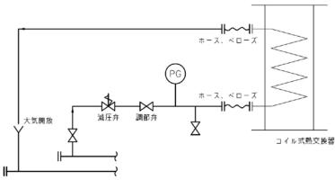
[図5.1] クーラー、コンデンサーとして使用した場合の配管例
