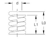
\*QV-DFSS10.5 の締付高さL1は、SUPRA LINE規格のフランジを使用する場合の高さです。
